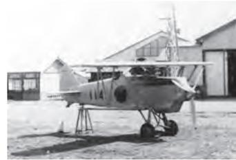
尾部を架台に載せて機銃の弾道調整中の
