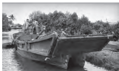
写真1 大発 V字の船底がよく見える
