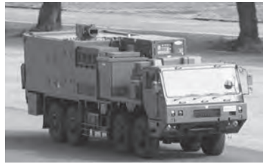
写真3 車両搭載高出力レーザー実証装置 (出典：防衛装備庁HP)
